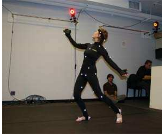
FIG. 2.3 – Système d’acquisition par marqueurs (NYU Motion Capture Studio)
