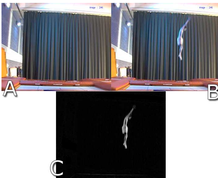
FIG. 2.7 – Extraction des données utiles d'une image par soustraction ( B - A \Rightarrow C ). (LIMSI-CNRS)
