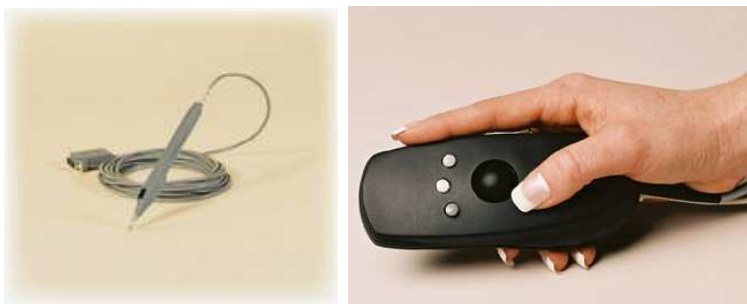
FIG. 4.3 – A gauche un stylet 3D (POLHEMUS), à droite un Wand (ASCENSION TECH.)
