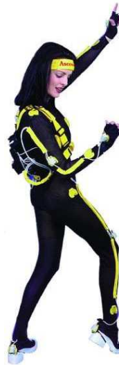
FIG. 2.4 – Le système de capture de position/orientation MotionStar™. A gauche le système avec fils, à droite le même système avec un émetteur radio. (Ascension Technology)
