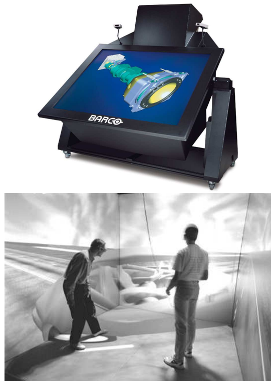
FIG. 4.1 – En haut un dispositif de type WorkBench (système Baron™ de chez BARCO), en bas un dispositif de type CAVE (Extrait de l'University Record du 5 nov. 97, Université du Michigan).
