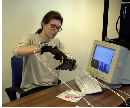
FIG. 2.5 – Exemple d'utilisation de gants numériques et de capteurs de position/orientation. (LIMSI-CNRS)
